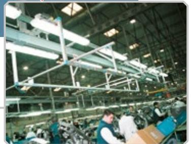
Linee di montaggio realizzate con HBS e carrelli scorrevoli per integrare in modo ergonomico sostegno e alimentazione di dispositivi pneumatici, elettrici e cavi dati. Gamma MTS.
