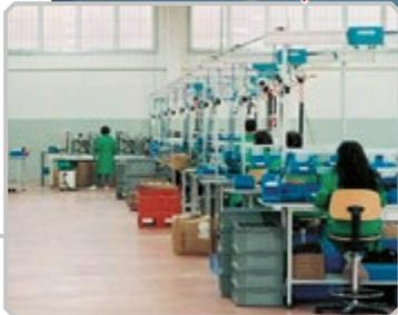
Banchi da lavoro ergonomici internamente pressurizzati, dotati di carrello ATS per alimentazione di tools elettrici e pneumatici e accessori personalizzati. Gamma WBA.
