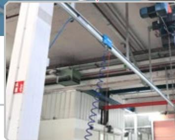
Carrelli scorrevoli su profilo di alluminio per integrare il sostegno e l'alimentazione in modo ergonomico di dispositivi pneumatici ed elettrici. Gamma MTS e ATS.
