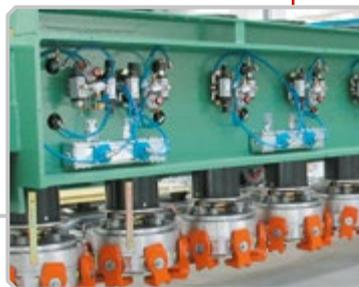
Collettori modulari di distribuzione a bordo macchine o linee automatizzate. Gamma AMS.
