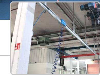
Carrelli scorrevoli su profilo di alluminio per integrare il sostegno e l'alimentazione in modo ergonomico di dispositivi pneumatici ed elettrici. Gamma MTS e ATS.
