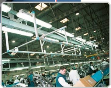
Linee di montaggio realizzate con HBS e carrelli scorrevoli per integrare in modo ergonomico sostegno e alimentazione di dispositivi pneumatici, elettrici e cavi dati. Gamma MTS.
