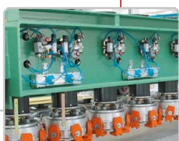
Collettori modulari di distribuzione a bordo macchine o linee automatizzate. Gamma AMS.
