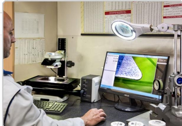
Provvediamo al controllo qualità del materiale seguendo il piano di campionamento secondo la norma UNI ISO 2859 e per ogni particolare a disegno si utilizza una scheda di controllo specifica.
