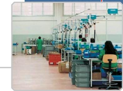
Banchi da lavoro ergonomici internamente pressurizzati, dotati di carrello ATS per alimentazione di tools elettrici e pneumatici e accessori personalizzati. Gamma WBA.
