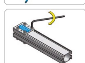
4.3. **Bloccaggio delle viti:** operazione da fare con scrupolo. Le viti vanno strette bene, ma senza esagerare per non strappare il filetto. La coppia di serraggio delle viti M6 è da un minimo di 10 N·m (91In.Lbs) ad un massimo di 13,5 N·m (120 In.Lbs).
