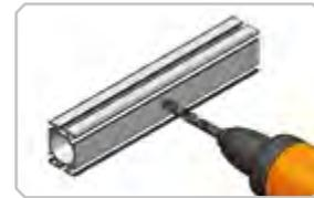
Der max. Durchmesser des Bohrloches und der Abschrägung darf den gem. Tabelle empfohlenen Durchmesser nicht überschreiten.
