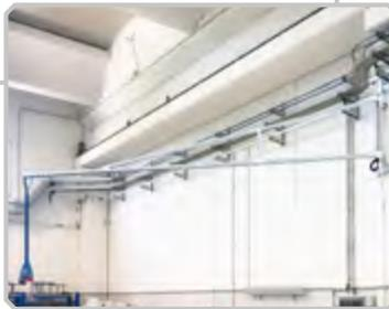
Tischschwenkarme aus eloxiertem Aluminium als Halterung von pneumatischen Werkzeugen. Produktpalette SAB.
