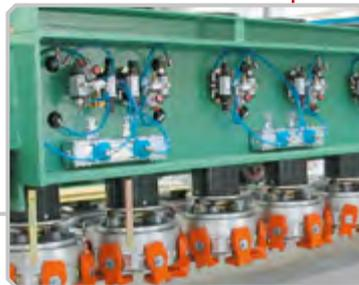
Modulare Verteiler auf Maschinen oder Automationslinien.
